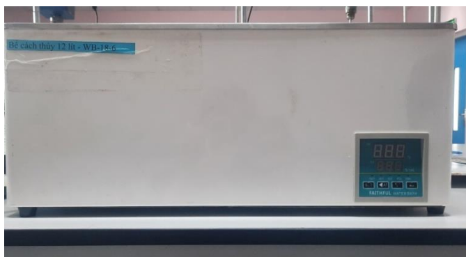
Hình 2.5. Bể điều nhiệt
