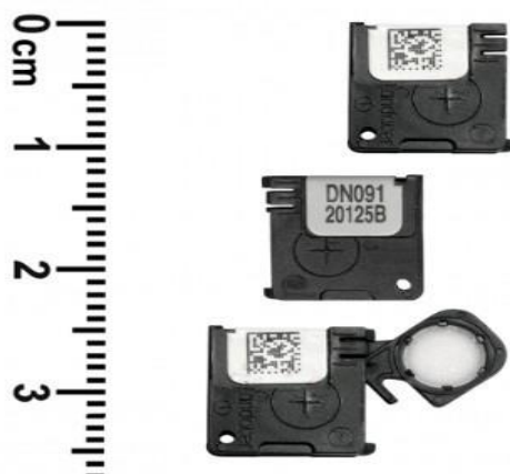
Hình 3.1 Cấu tạo liều kế nanoDot
