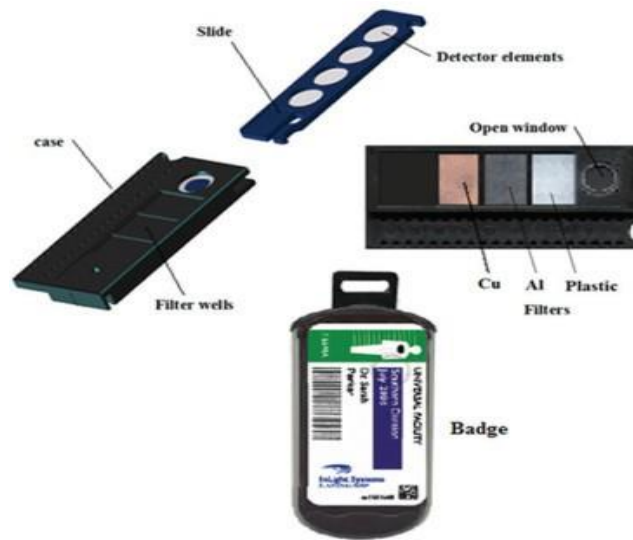
Hình 3.2 Cấu tạo của liều kế Inlight
