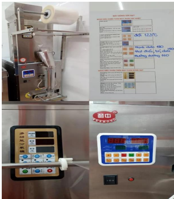
Hình 2. 8: Thiết bị đóng gói hạt tự động, các thông số và bảng chỉ dẫn điều chỉnh thông số
