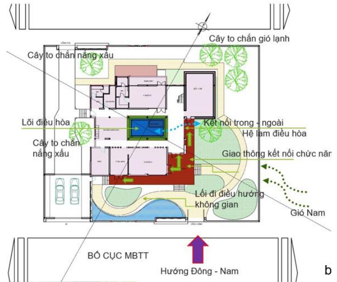
Hình 7 a. Mặt bằng tổng thể công b. Mặt bằng tổ chức không gian biệt thự – sự đối lưu không khí
