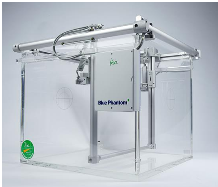
Hình 2.10 Phantom nước Nguồn hình: IBA, Germany
