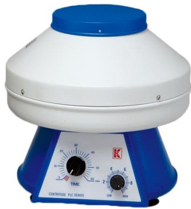
Hình 2.2. c) Máy ly tâm 4000 vòng/phút, 12x15ml và d) Bể rửa siêu âm PS-40A Trung Quốc Gemmy PLC-05
