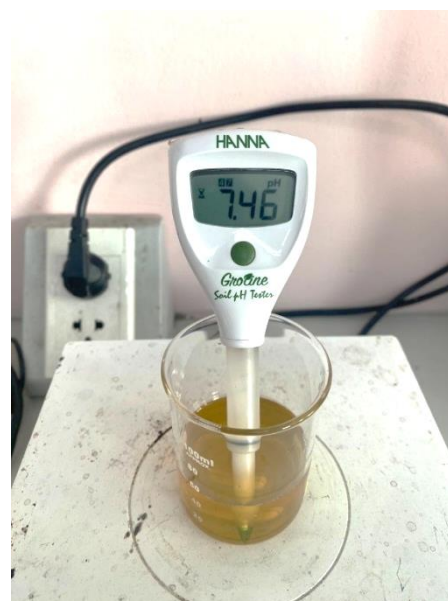
Hình 2.1. a) Cân phân tích 3 số Mỹ, PX223/E 001 và b) Bút đo pH Hanna HI 981036
