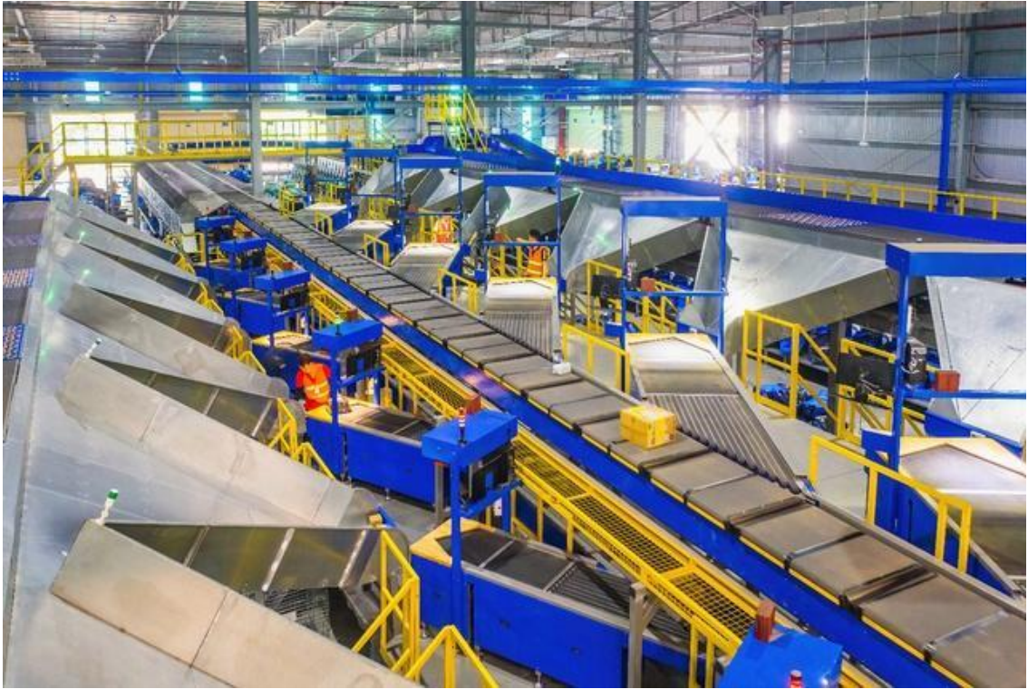
Hình 2.2 Hệ thống phân loại hàng hóa tự động ở trung tâm chia chọn hàng Lazada
