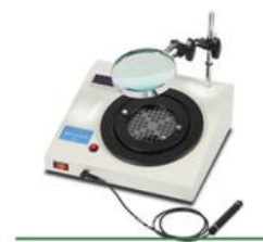
Hình 2.7. Máy đếm khuẩn lạc FTCC-10 (Sci Finetech, Hàn Quốc)
