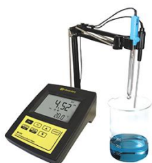
Hình 2.2. Máy đo pH để bàn MI 150 (Milwaukee Instruments, Romania).
