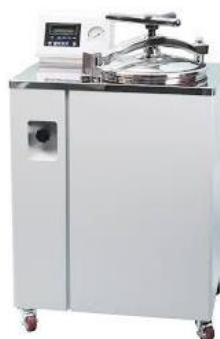
Hình 2.5. Thiết bị nổi hấp tiệt trùng HAC080 (LK LAB, Hàn Quốc).
