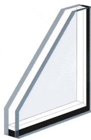
Hình 2.3: Hình minh họa kính ghép hộp
